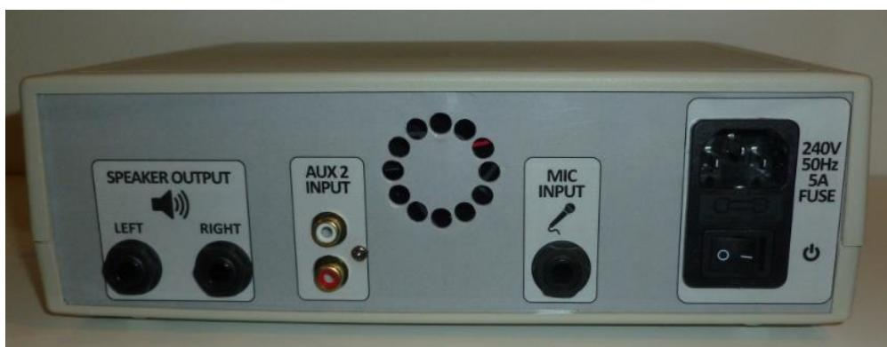
2. Ligue o cabo da chaleira à tomada na parte de trás do amplificador (tomada superior direita rotulada como 240 V). Ligue usando o interruptor na parte de trás do amplificador (canto inferior direito). A luz indicadora de energia na frente do amplificador deve acender (canto inferior direito da frente do amplificador).
